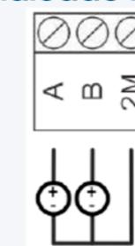
A ligação é semelhante nos 2 modos de operação (tensão ou corrente).
